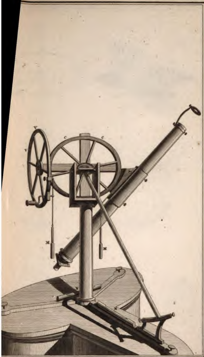
c c Est le cercle dirigé dans le plan de l'équateur . v v Le cercle vertical sur lequel on mesure la déclinaison . m m Des rappels qui permettent de mouvoir à volonté la lunette . x x Niveaux qui attestent la verticalité du pied de l'instrument .
